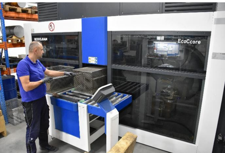
Das Reinigen der Teile vor der Wärmebehandlung, um sie von Verschmutzungen und Emulsionen zu befreien, erfolgt in einer über MAP PAMMINGER bezogenen, kompakten Lösemittel-Reinigungsanlage EcoCcore von Ecoclean.
