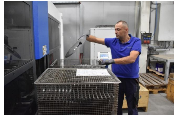
Die Reinigung erfolgt in Körben des Herstellers Kögel mit 670 x 480 x 400 mm mit Deckel und gefederten Fachstangen zum Separieren der Teile.
