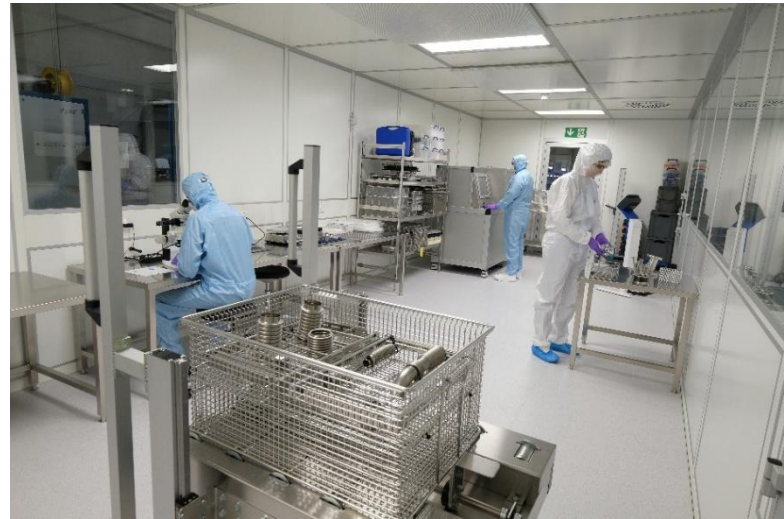
Für die Prozessauslegung und Definition der Prozessparameter unter produktionsnahen Bedingungen steht ein High Purity-Test Center mit Reinraum und verschiedenen Mess- und Analyseverfahren zur Verfügung, in dem auch Lohnreinigungsaufträge durchgeführt werden.
