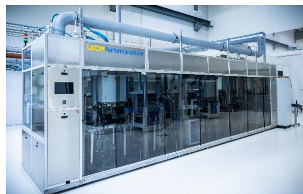
Ob große Materialvielfalt, hohe Durchsatzanforderungen und/oder strenge Sauberkeitsspezifikationen, modular aufgebaute Ultraschall-Mehrbadtauchanlagen lassen sich effizient an die jeweilige Aufgabenstellung anpassen – auch für die Integration in beziehungsweise den Anschluss an einen Reinraum.
