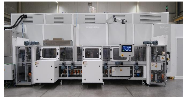
Bei Kammeranlagen, wie diesem Zweikammer-Reinigungssystem für wasserbasierte Prozesse, werden Konstruktion, Anlagentechnik, Medienführung und-aufbereitung speziell an die spezifischen Anforderungen in der Feinst- und High Purity-Reinigung angepasst.
