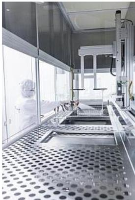
Konstruktion, Verarbeitung und Ausstattung der Anlagen verhindern, dass es zu Re- und Kreuzkontaminationen kommt. Sie sind ausgelegt für eine Anbindung beziehungsweise Integration in einen Reinraum.
