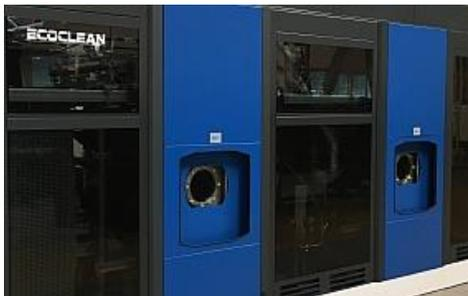
Die Konstruktion und spezielle High Purity-Ausstattung der Doppelkammeranlage für wasserbasierte Medien ermöglicht die effiziente Reinigung auch großer Bauteile, bei der Sauberkeitsspezifikationen entsprechend Grade 2 stabil erreicht werden.
