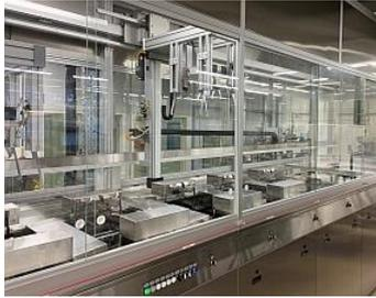
Bei einer großen Materialvielfalt, hohen Durchsatzanforderungen und Sauberkeitsspezifikationen entsprechend Grade 2 und 1 sind Mehrbad-Ultraschallreinigungsanlagen durch beliebig kombinierbare Reinigungs- und Spülstationen – auch mit unterschiedlichen Reinigungsmedien und Spülwasserqualitäten – eine optimale Lösung.
