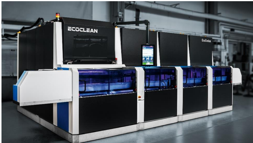
Die neue EcoCvelox kombiniert das Entgraten und Reinigen mit einer sehr schnellen Automation, so dass diese Prozesse effizient in einer Anlage aus einer Hand durchgeführt werden können. Auf dem 19 Zoll großen Flatscreen-Bildschirm (HMI) des neuen, intuitiven Bedienpanels wird jedes Modul der Anlage in einer Komplettübersicht, ähnlich wie auf einem Smartphone, separat und übersichtlich dargestellt.
