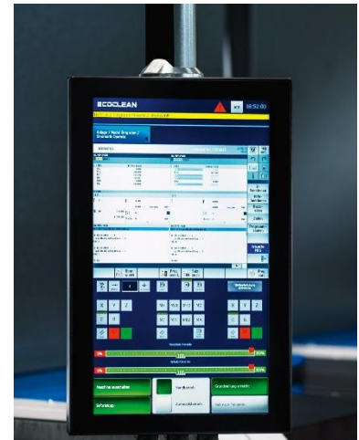
Die neue EcoCvelox kombiniert das Entgraten und Reinigen mit einer sehr schnellen Automation, so dass diese Prozesse effizient in einer Anlage aus einer Hand durchgeführt werden können. Auf dem 19 Zoll großen Flatscreen-Bildschirm (HMI) des neuen, intuitiven Bedienpanels wird jedes Modul der Anlage in einer Komplettübersicht, ähnlich wie auf einem Smartphone, separat und übersichtlich dargestellt.
