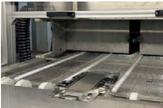
Prozesssichere Reinigung, Entfettung und Oberflächenvorbereitung von Bipolarplatten als Voraussetzung für Beschichtungs- und Funktionsprozesse in Brennstoffzellen.
