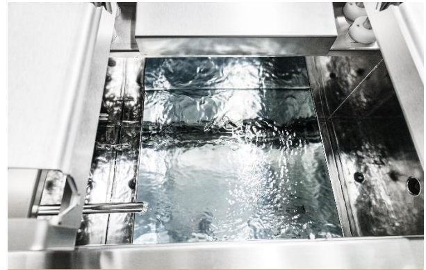
Alle Wannen für Nassstufen der komplett aus elektroplattiertem Edelstahl gefertigten Anlage verfügen über einen Zweiseitenüberlauf, durch den abgereinigte Partikel und andere Verschmutzungen sofort ausgetragen werden. Dies minimiert das Rückkontaminationsrisiko beim Umsetzen der Teile.
