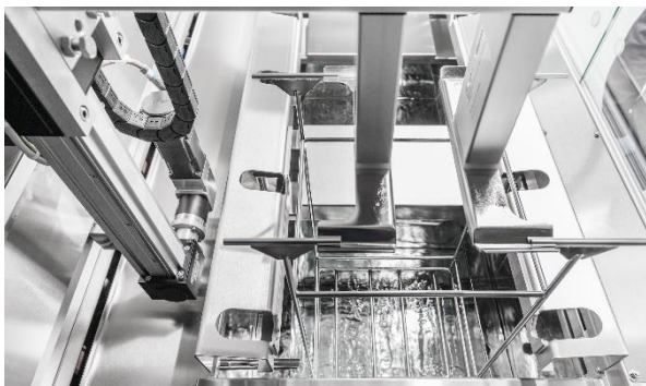
Der serienmäßige Transportautomat verfügt über einen Servoantrieb für einen sehr schonenden Werkstücktransport und teilespezifischen Lift-Out zur Vortrocknung aus dem letzten Spülbecken.
